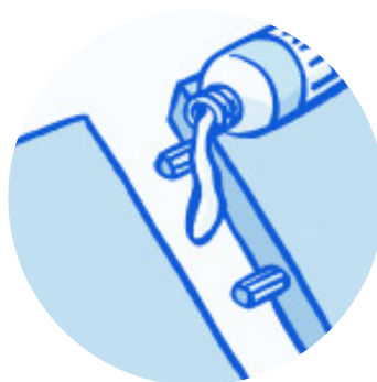
Bevestiging met deuvels en houtlijm
